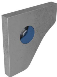
Rysunek 6. Kotwa płaska umiejscowiona w otworze Ø 34mm przesłonięta zaślepką ze stali nierdzewnej lub betonową w różnych kolorach
